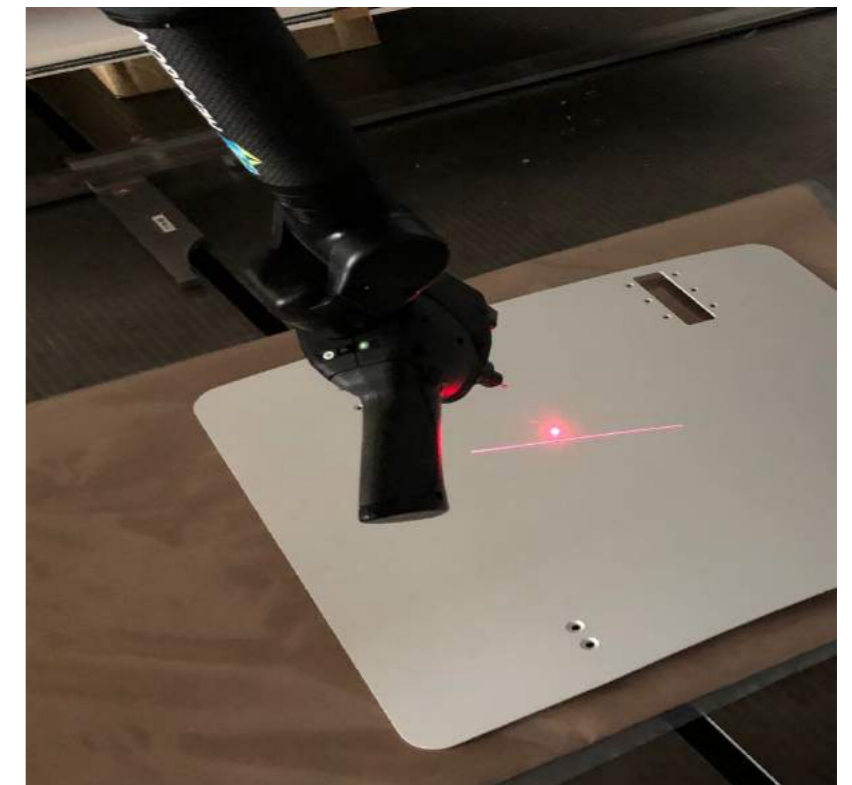
Scannen einer Belly Fairing Wartungsabdeckung
