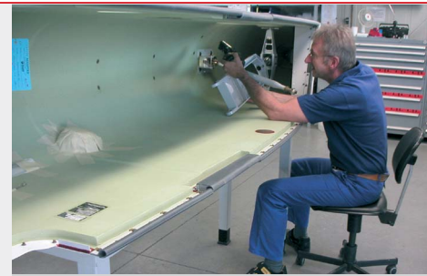
Ausrüstung von Flap-Track-Fairings für die Flügelmontage bei Aljo
