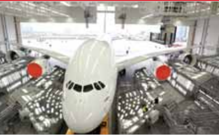
Die erste mit dem neuen Lacksystem versehene A380 verlässt die Halle.
