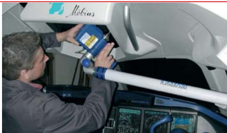
Mobiles Laser-Scansystem im Einsatz bei Möbius Modellbau
