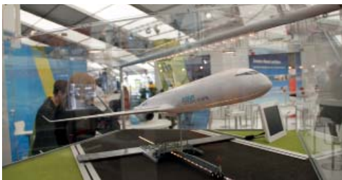
Modell eines fahrwerklosen Flugzeuges auf der ILA Berlin 2014
