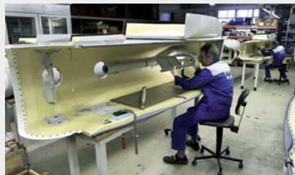
Ausrüstung von Airbus A330 Flap-Track-Fairings bei Aljo
