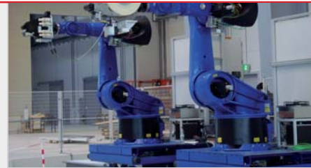
Neue Fiber-Placement-Anlage im Zentrum für Leichtbauproduktionstechnologie (ZLP) in Stade
