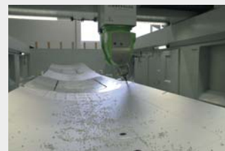
5-Achsen FZ-32 HSC Portalfräsmaschine bei der Firma Eickworth in Bremen.
