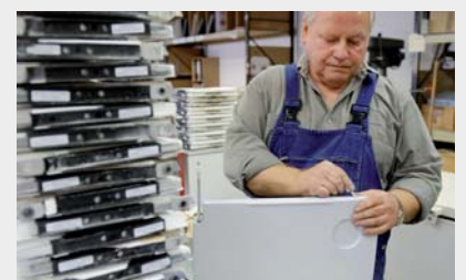
Bei der Überholung muss jeder Klapptisch manuell montiert beziehungsweise demontiert werden.
