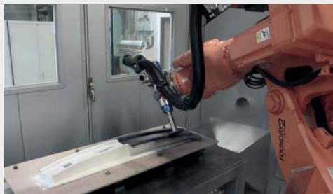
Robotergeführtes Trennschleifen von Faserverbundwerkstoffen
